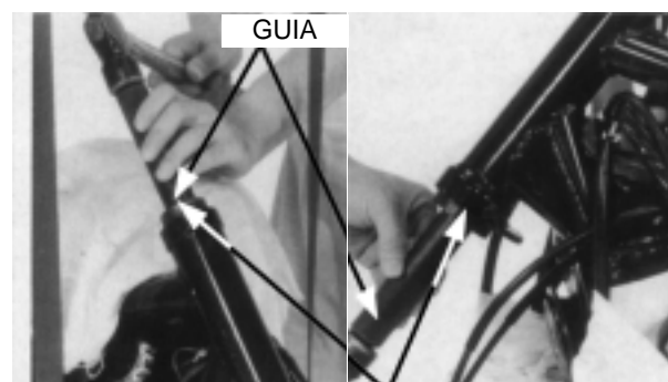
REMOVEDOR /INSTALADOR DE PISTA DE ESFERAS
